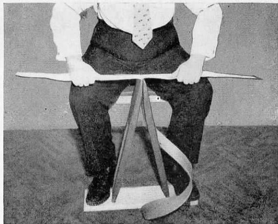
Fig. 6. Une grosse clisse séparée en deux dans la fendeuse
